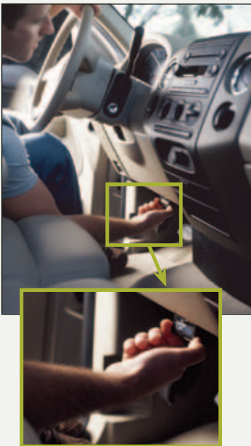
CarChip Pro se conecta de manera instantánea y discreta en el puerto OBDII de su automóvil o camión.
